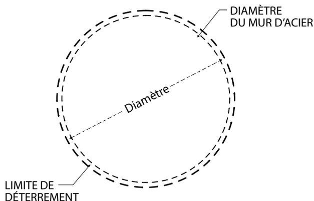
Plantez un pieu au centre de l'emplacement et, à l'aide d'un ruban à mesurer, tracez un cercle dont le rayon sera de 15 cm à 20 cm (6" à 8") de plus que celui du diamètre du mur d'acier. (voir illustration 1.1)
