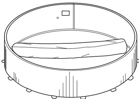
Amenez la toile par-dessus le sommet du mur en laissant excéder entre 10 cm à 15 cm (4" à 6") à l'extérieur du mur. Maintenez ensuite la toile en place, à l'aide d'un coupleur de plastique (pas inclus). Installez la rainure du haut en résine sur le mur et installez la plaque du haut sur chacun des poteaux.
