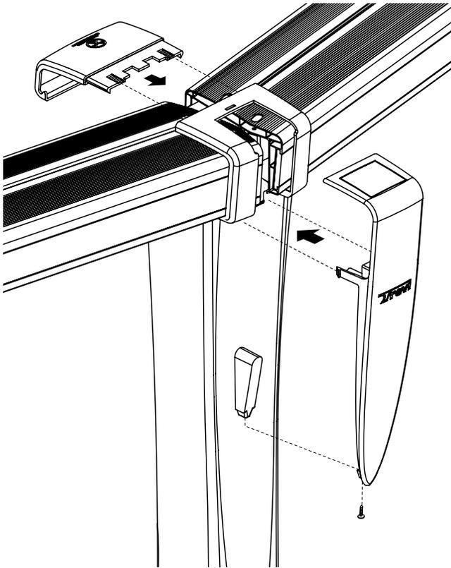
Accrochez le couvre-joint sur le rebord intérieur des sièges et l'enclencher sur le poteau.
