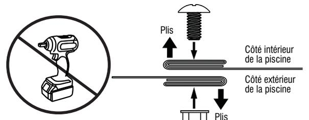
**IMPORTANT :** Ne pas utiliser de pistolet à chocs (impact gun) pour visser les vis à mur. Serrage minimum de 60 livres pouce et maximum de 85 livres pouce.
